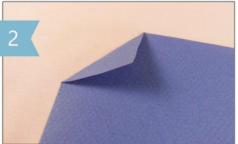
Pliez la matière dans un angle pour obtenir deux épaisseurs. Réglez la sortie de lame\* sur une valeur correspondant approximativement à l'épaisseur du matériau.
